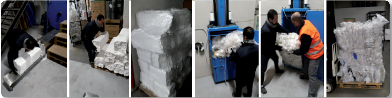
Figura 3- Proceso de compactación del EPS (briquetas) y del PE (balas). Figure 3- EPS (briquettes) and PE (bales) compacting processes.
